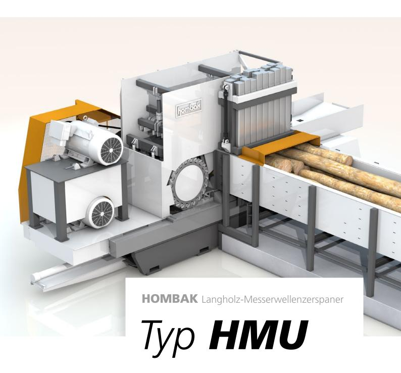
Der Einstufenzerkleinerungsprozess, vom Baumstamm zum Qualitätsholzspan
